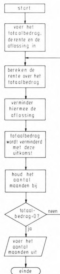
Fig. 1. Algemene flow-chart. We zien hierin duidelijk hoe we een bepaald probleem willen aanpakken, onduidelijk is echter nog hoe we de instructies kiezen.
